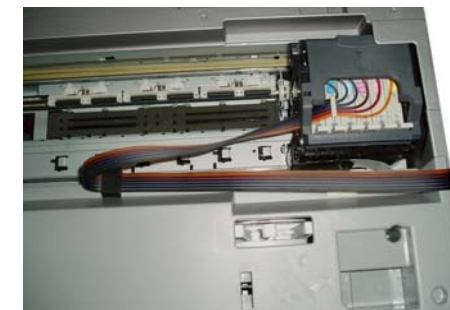
вариант крепления на EPSON RX500
