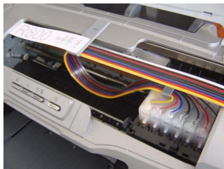
вариант крепления на принтере R800
