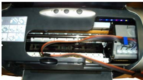
вариант крепления на принтере EPSON SYLUS PHOTO R200
