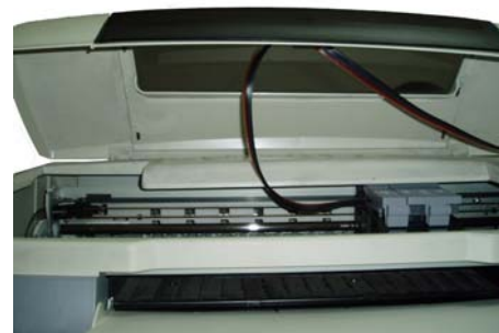
вариант крепления на принтере 1290
